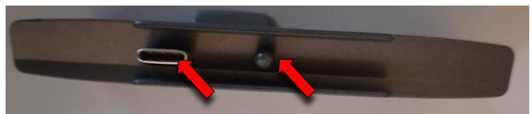
Abb. 8: Anschluss der Docking Station. Die „Nase“ dient der Stabilisierung.
