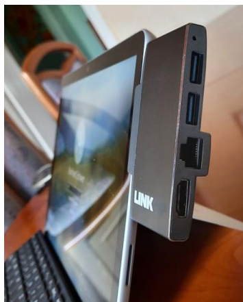
Abb. 7: Docking-Station mit Ausgang für USB 3.0, HDMI und Netzwerkkabel
